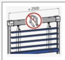
Construction de stores autoporteuse
