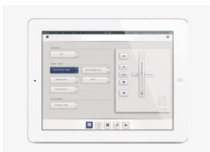
Commande KNX / gBUS par iPad
