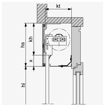
En manœuvre manuelle, la lame finale se trouve à 20 mm sous le linteau.
