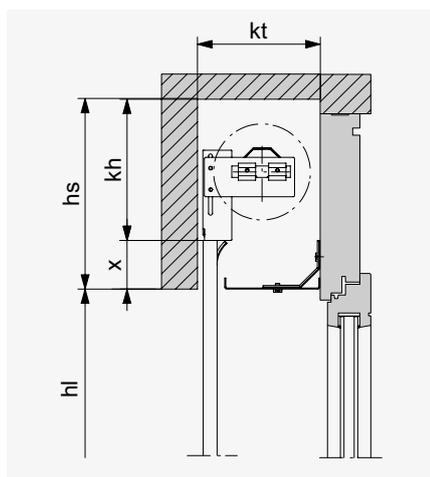
Avec sous-face. En manœuvre manuelle, la lame finale se trouve à 20 mm sous le linteau.
