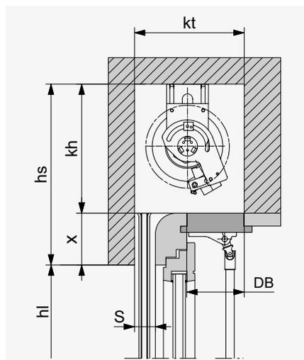
En manœuvre manuelle, la lame finale se trouve à 20 mm sous le linteau.
